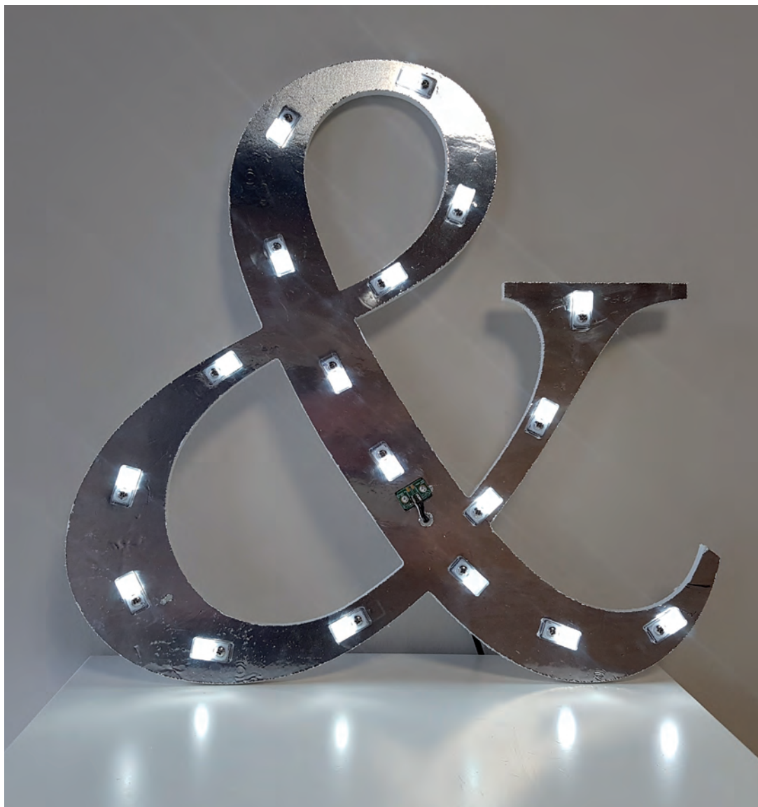
Een in de gewenste vorm gesneden PowerBoard, voorzien van de draadloze Quantum ledmodules.
